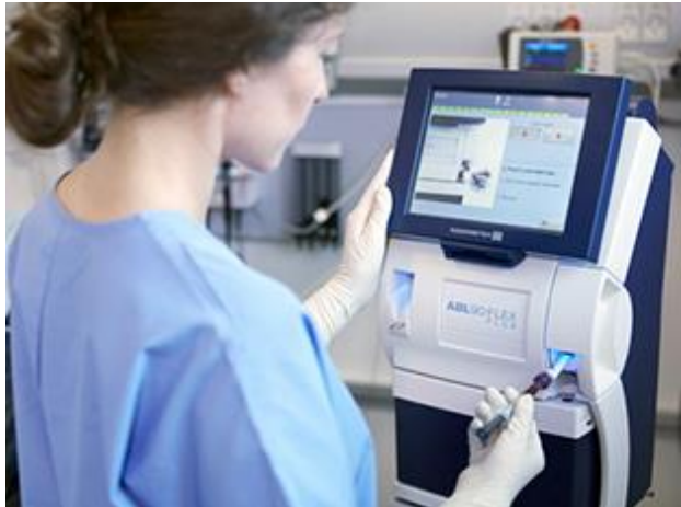
Illustrasjon av "bedside" blodgassanalyse med et moderne Radiometer ABL 90 apparat
